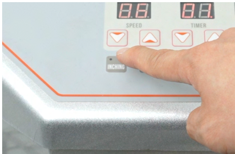
INCHING기능을 통해 자세한 반죽상태 확인 및 좀 더 정교한 조작이 가능합니다
