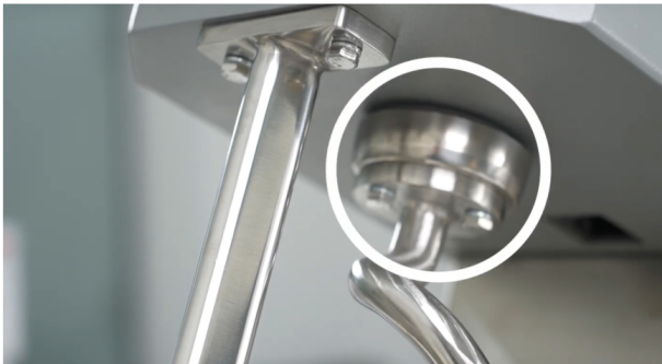
스테인리스 볼과 중심핀, 혹은 이물질이 없도록 항상 청결하게 유지해주세요
