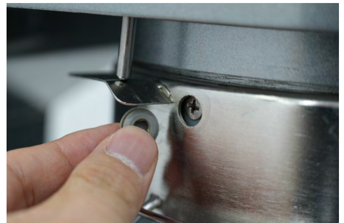
안전커버에 러버2개를 제거한 뒤 안전커버를 돌려가며 볼트3개 위치를 찾아주세요
