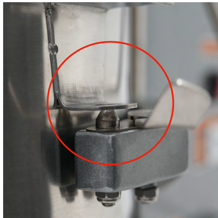
⚠ 볼 결합 봉과 볼 양 날개가 홈에 정확하게 결합되지 않은 상태에서 기기 작동시 고장이 발생할 수 있습니다.
