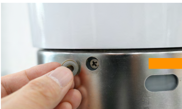
안전커버 러버(총3개)가 풀려있을 경우 안전 커버 센서 접지에 영향을 줄 수 있습니다
